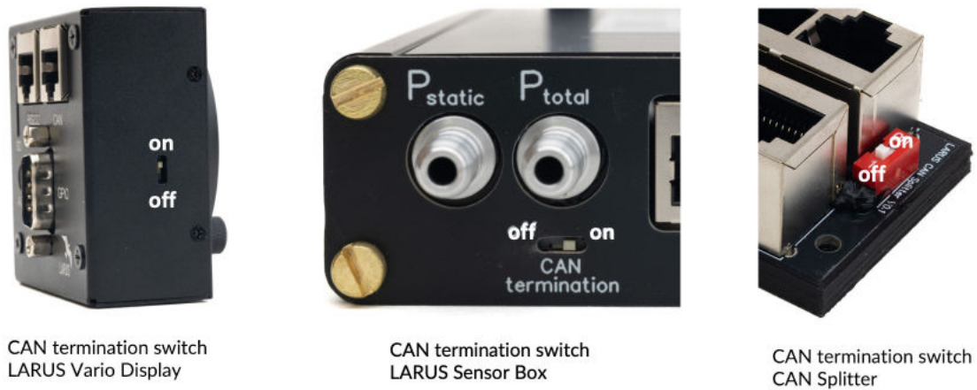
Abbildung 6: Schalter an den Geräten zur Terminierung des CAN Bus
